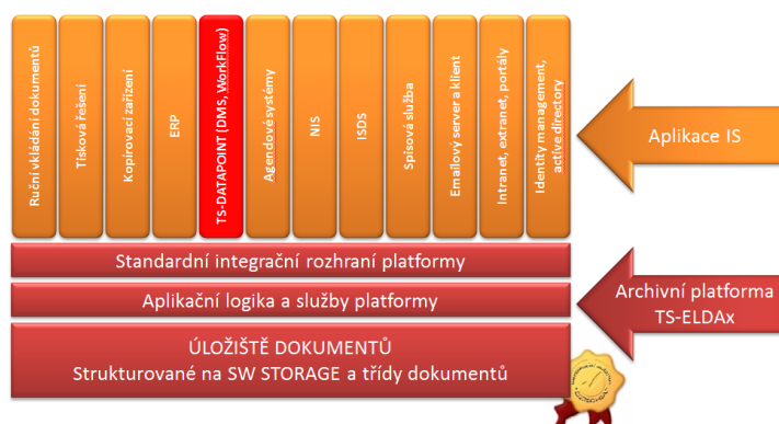
Obrázek 1 - Umístění a role archivní platformy TS-ELDAX v architektuře IS
